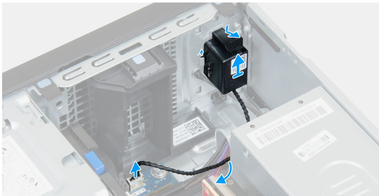
Afbeelding 18. De interne luidspreker verwijderen
