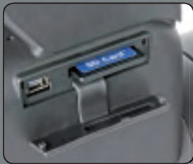
SD-Speicherkartenslot* und USB-Anschlussbuchse** Card slot for SD memory cards* and USB connection thread**
