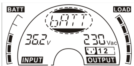
■ Режим работы от батарей
