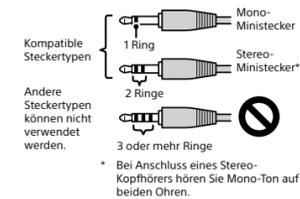
Bei Anschluss eines Stereo-Kopfhörers hören Sie Mono-Ton auf beiden Ohren.
