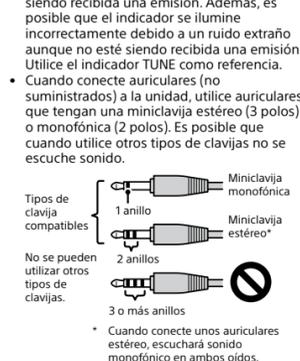
No se pueden utilizar otros tipos de clavijas.
