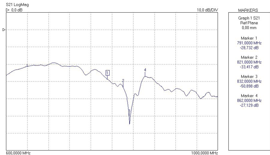
Figuur 5: Ontkoppeling tussen de antennes
