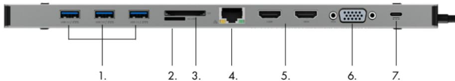
1. 3x USB 3.0 Type-A data interface/Datenschnittstelle + 1.5 A charging/aufladen
